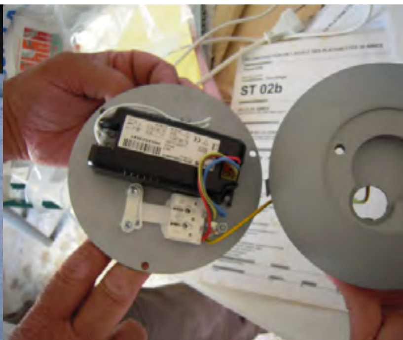
↑ Essais de fixation des luminaires sur plafond fibre de bois ↓ Vérification des modes d'assemblage et fixation sur luminaires
