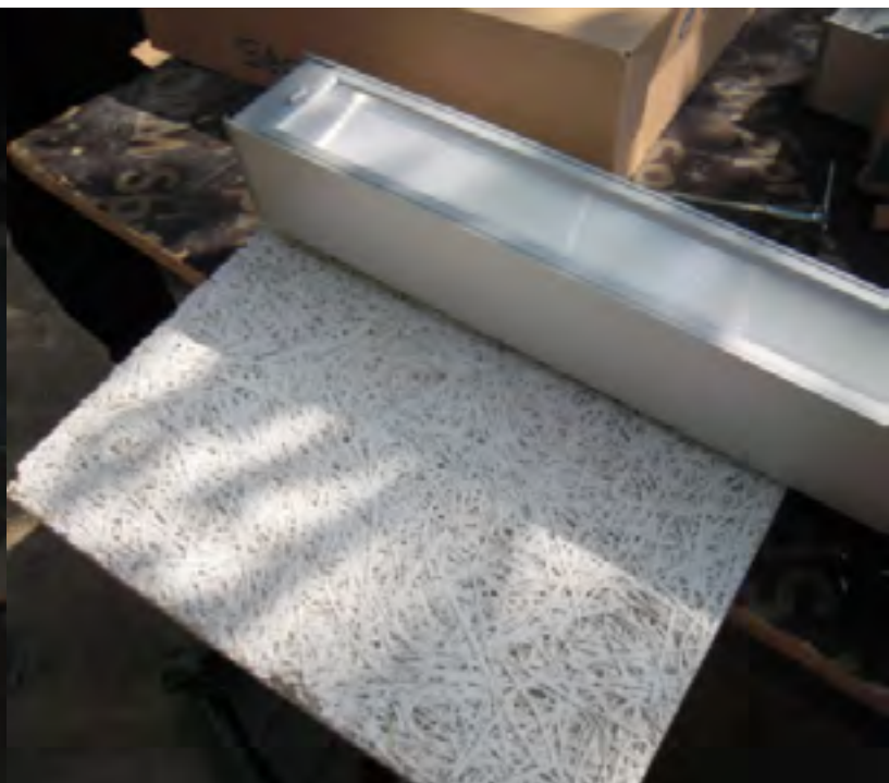
↑ Essais de fixation des luminaires sur plafond fibre de bois ↓ Vérification des modes d'assemblage et fixation sur luminaires
